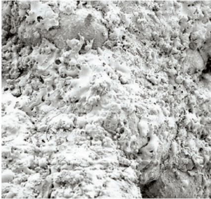
REM-Aufnahmen einer HA-gespritzten Oberfläche
