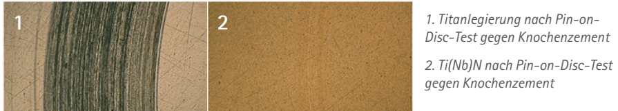
Verschleißfestigkeit von Ti(Nb)N-Schichten im Pin-on-Disc-Test gegen Knochenzement
