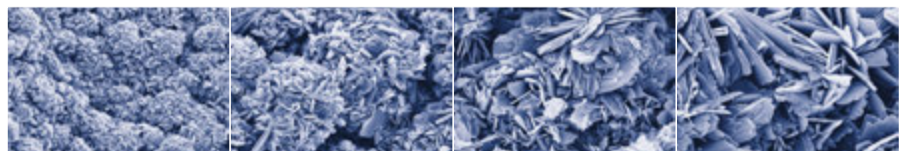
REM-Aufnahmen einer BONIT®-beschichteten Oberfläche
